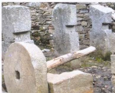
Fig. 6. Montanti, supporto dell'albero a camme e ruota-volano del maglio.
