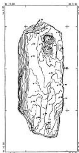
**Fig. 7.** Restitution sur papier du lever stéréophotogrammétrique réalisé avec les stéréophotographies présentées à la fig. 4: unité de mesure des cotes en dm; cote conventionnelle du plan d'appui 1,000 dm; équidistance des courbes de niveau 2 mm (restitution réalisée par le Laboratorio di Fotogrammetria Analitica du Dipartimento di Georisorse e Territorio du Politecnico de Turin, opérateur Guido Malan).
