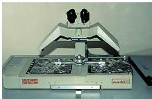
*Fig. 6. Restituteur analytique STEREOBIT 20 GALILEO SISCAM.*
