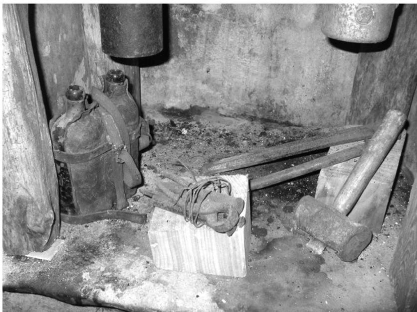
Fig. 6. Attrezzatura da minatore di Domenico Perino oggi esposta al Museo Civico Alpino di Usseglio: è composta da due barramine, mazzuolo con manico in legno di frassino, due scalpelli a sezione circolare, scalpello a sezione quadrangolare, tenaglie e coppia di bottiglie in vetro con portabottiglie in cuoio (dono Antonio Perino, numeri di inventario 05/04/1-8; foto Maurizio Rossi 2013).
